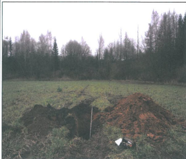
Místo kopané sondy a charakter výkopku
